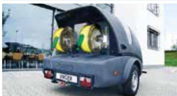
Adatto per veicoli con capacità di rimorchio di almeno a 1.500 kg. Serbatoio ad alta capacità, integrato in chassis dalla struttura leggera per manovre sicure. Approvato TÜV, monoasse, freno integrato, illuminazione e indicatori di direzione. Fornito con giunto standard europeo, ruota di appoggio e freno a mano, nonché piedistallo per stabilità. Conforme UE.
